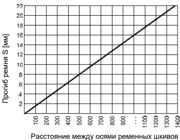
Рисунок 23. Прогиб клинового ремня в зависимости от расстояния между осями ременных шкивов
