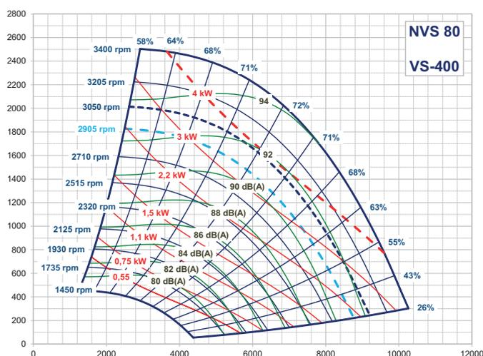
Статическое давление вентилятора в зависимости от расхода воздуха  $P$  [Па] =  $f(V [m^3/ч])$
