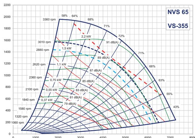
Статическое давление вентилятора в зависимости от расхода воздуха  $P$  [Па] =  $f(V [m^3/ч])$
